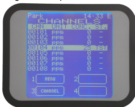
Figura 41) Videata con canali in Test
