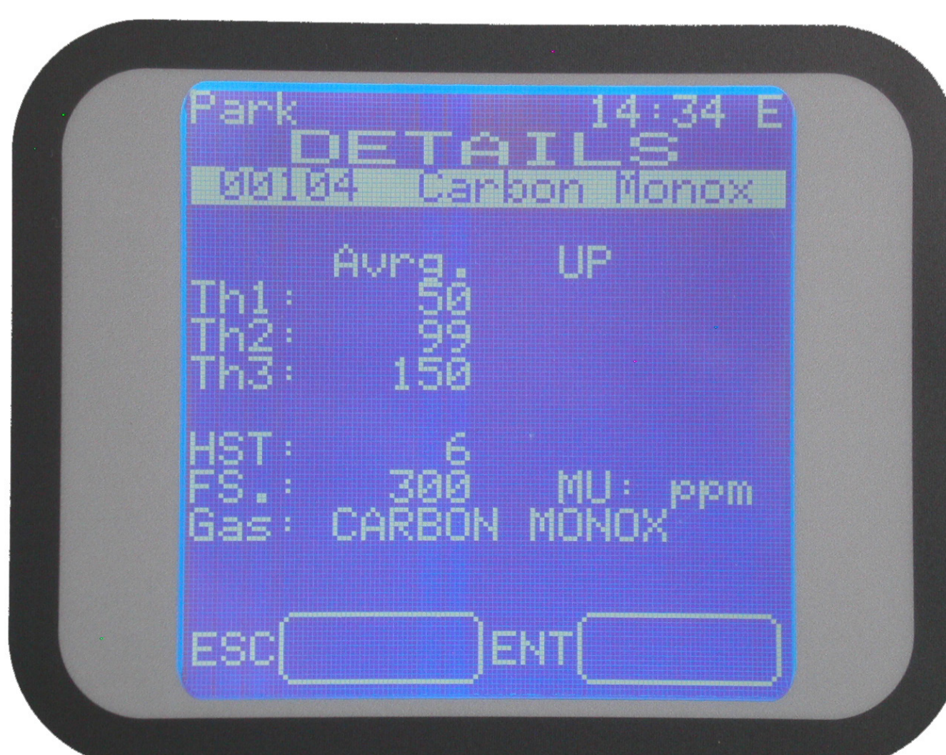
Figura 44 Dettagli configurazione rilevatore gas
