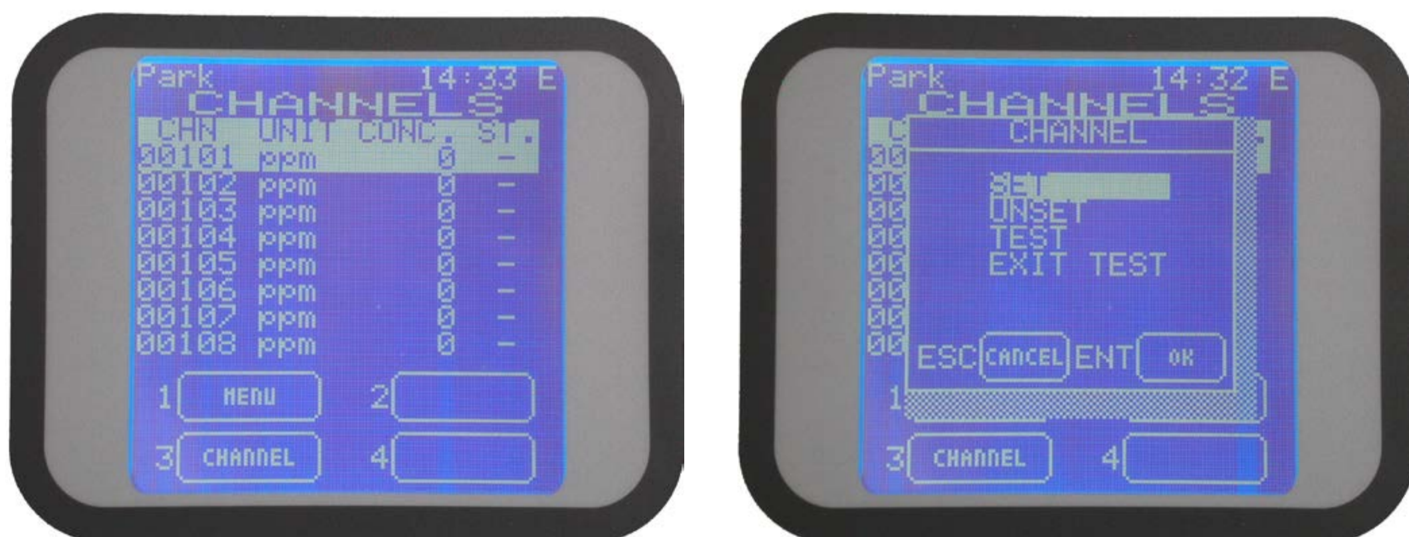
Figura 41 Videata rilevatori ed opzioni disponibili selezionando 3-CANALI
