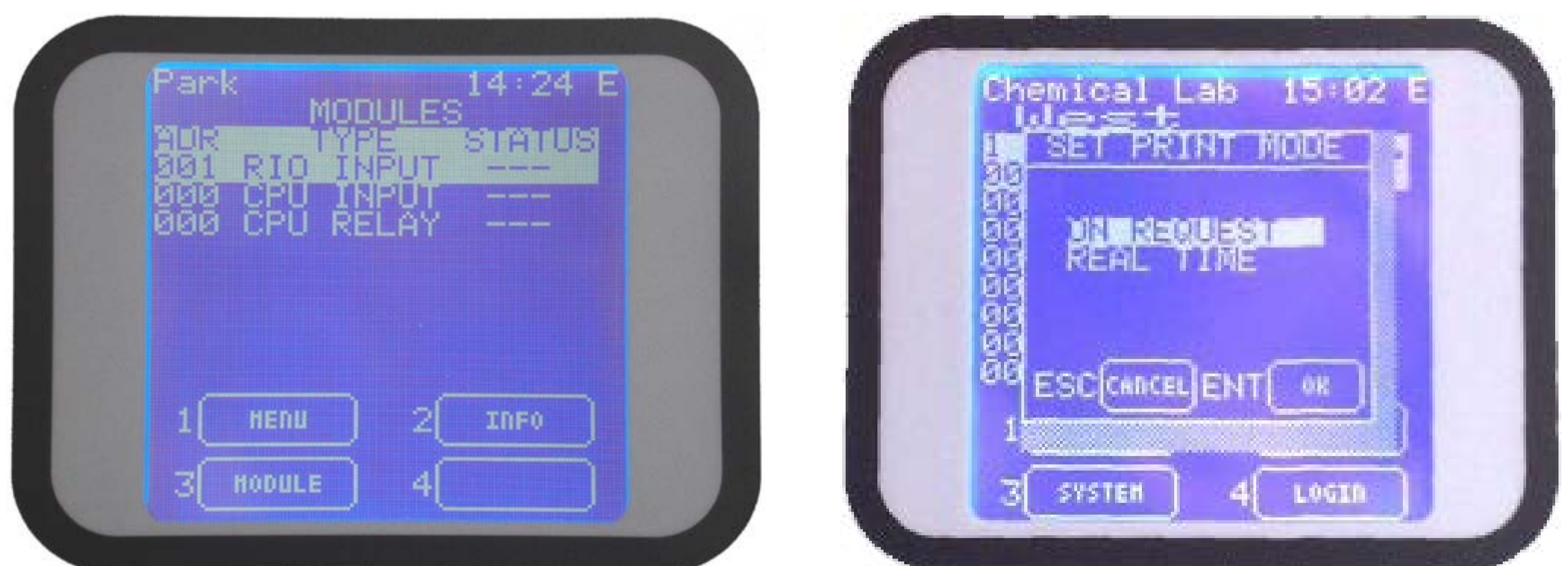
Figura 37 Videata Moduli ed opzioni disponibili premendo 3-Modulo
