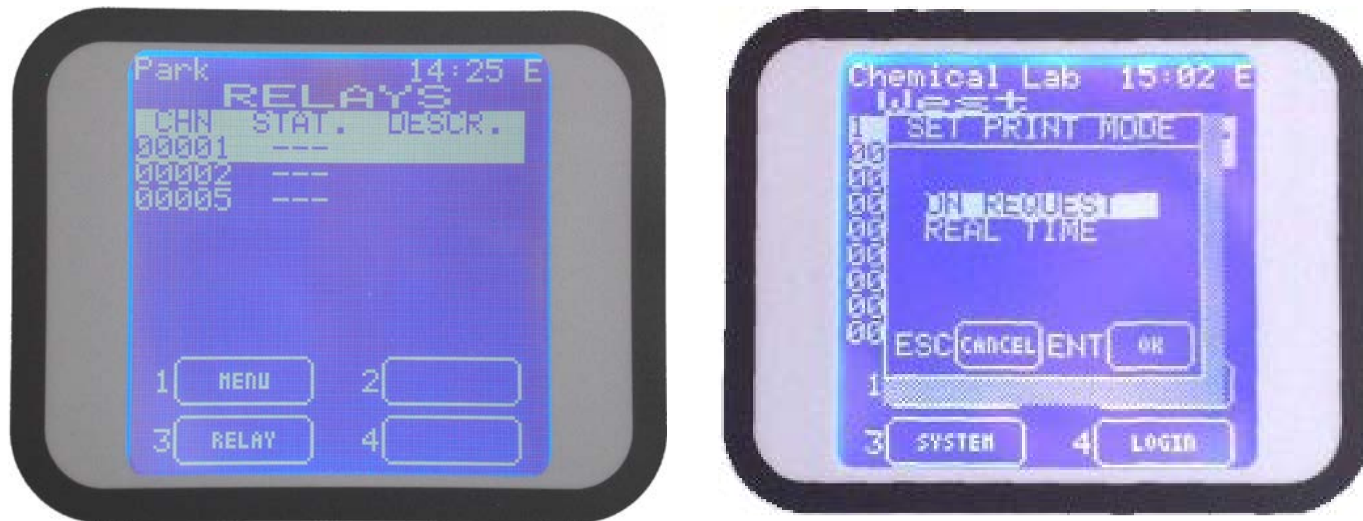
Figura 38 Videata uscite ed opzioni disponibili premendo 3-Relè
