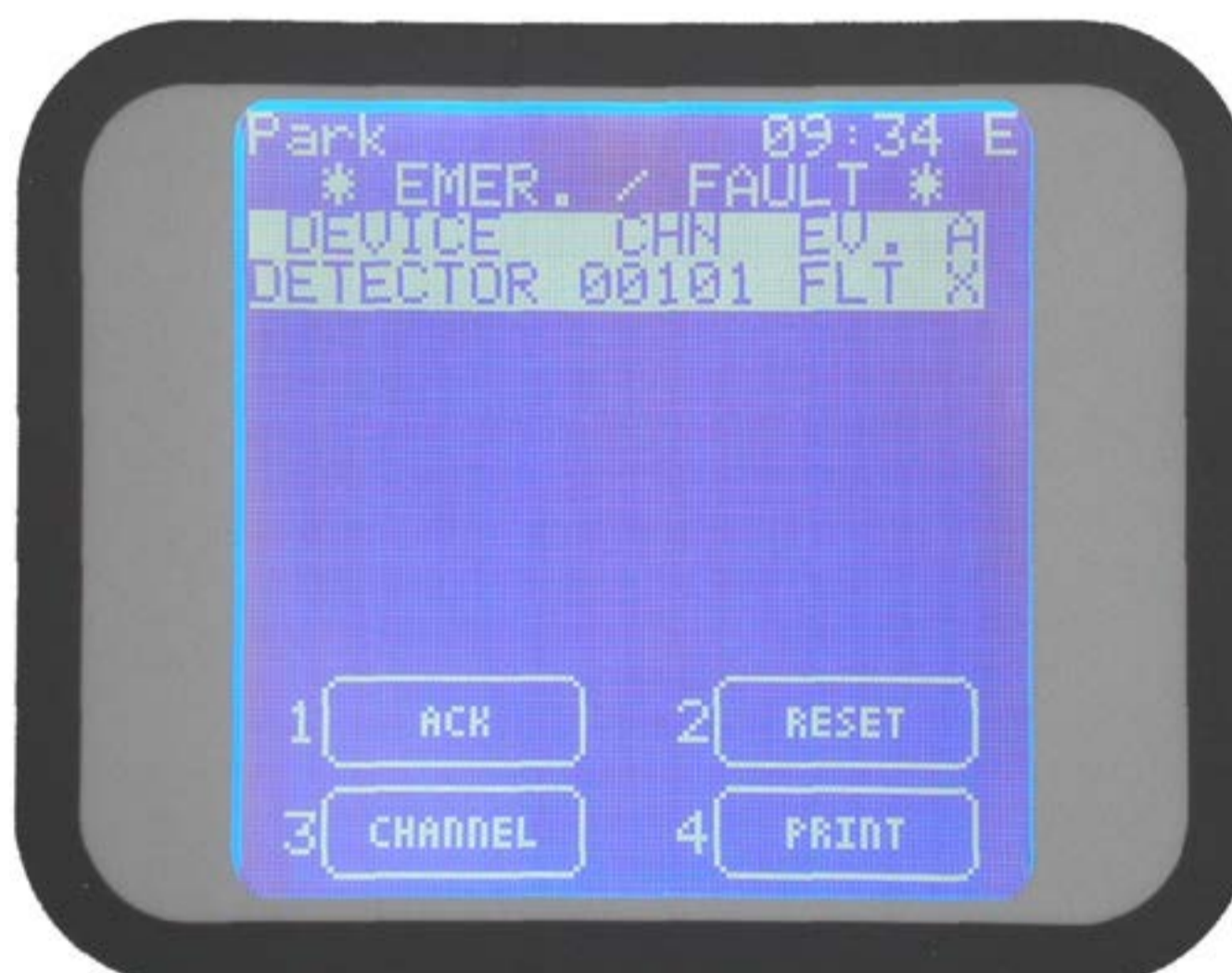
Figura 24 Videata in stato di Guasto
