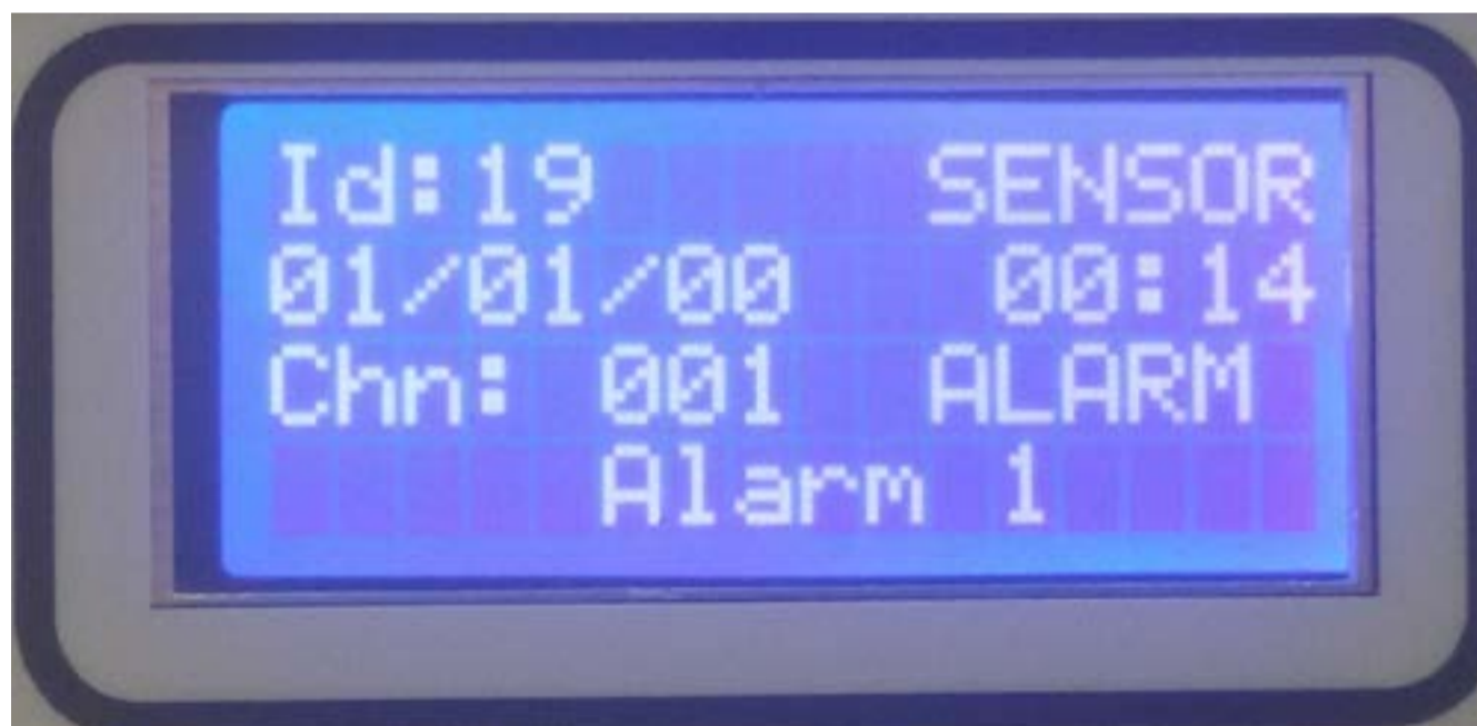
Figura 24 Dettagli evento di Allarme 1
