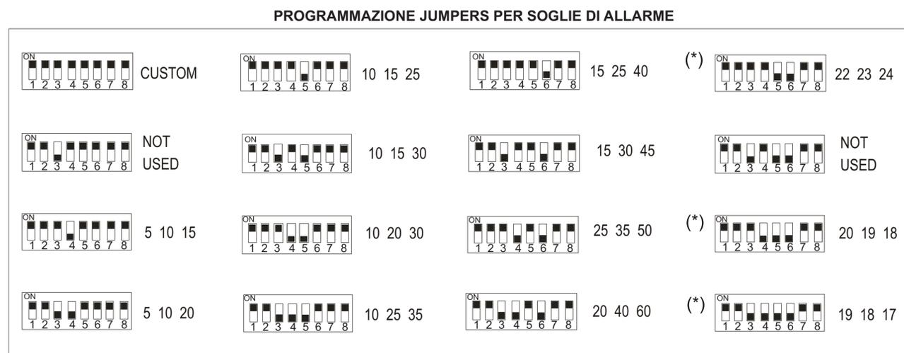
I VALORI SONO IN % DEL FONDOSCALE (VALORI ASSOLUTI NEL CASO DI RILEVAOTRI PER OSSIGENO)
